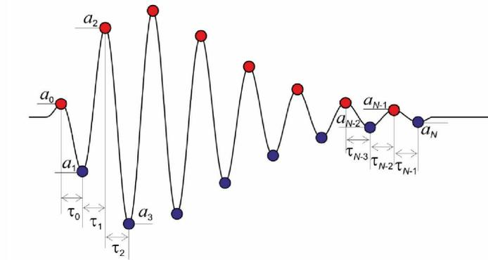
Рисунок 1. График импульсного сигнала с отмеченными локальными экстремумами:  $a_i$  – значения амплитуд,  $\tau_i$  – значения временных интервалов между экстремумами
