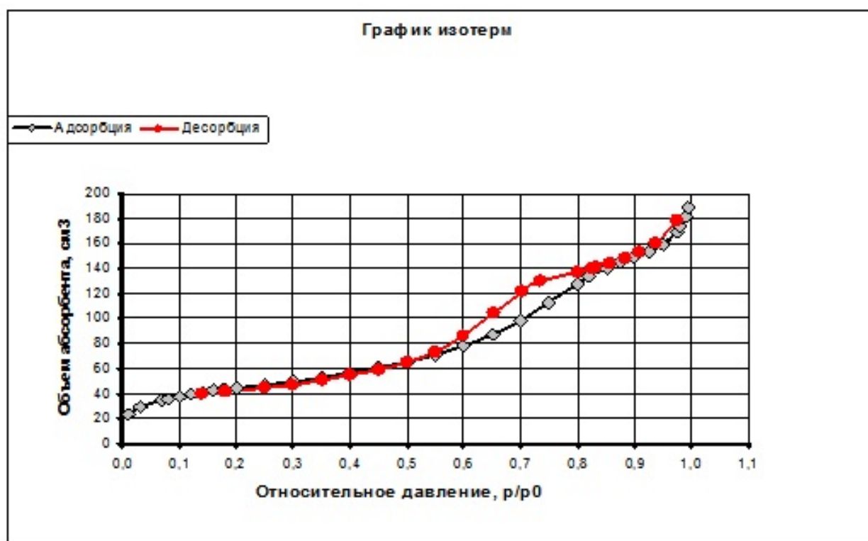
Рис. 4. Кривые сорбции – десорбции для порошка УФ-44
