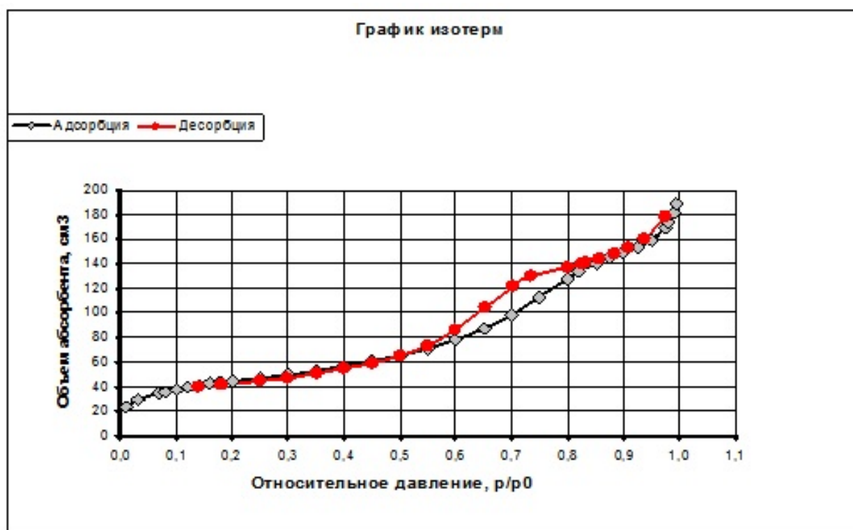
Рис. 4. Кривые сорбции – десорбции для порошка УФ-44
