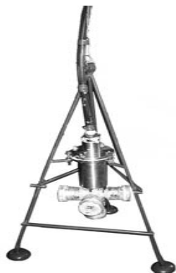
Рис. 1. Акустическая система из четырех направленных гидрофонов.
