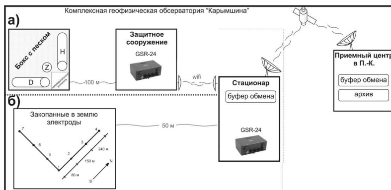
Рис. 2. Схемы передачи данных геомагнитных (а) и электротеллурических (б) наблюдений и расположения линий регистрации разности электротеллурических потенциалов на КГО Карымшина.
