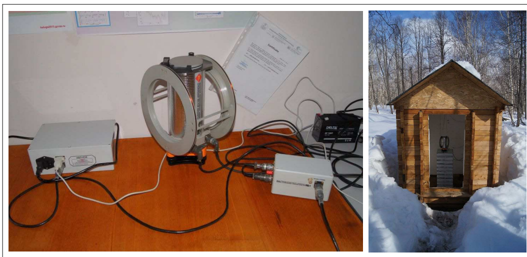
Рис. 1. Векторный магнитометр POS-4. На левой панели: слева – источник бесперебойного питания, в центре – датчик (соленоид и колечная система на трегере), справа – электронный блок. На правой панели: павильон POS-4 – датчик магнитометра установлен на постаменте из стеклблоков, дверь в павильон съемная, на латунных болтах (март 2016 г.)
