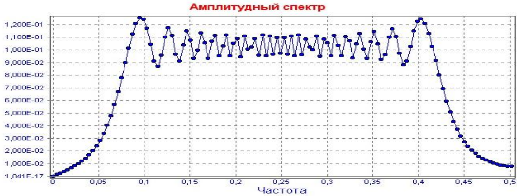
Рис. 1. Обработка ЛЧМ сигнала на основе преобразования Фурье
